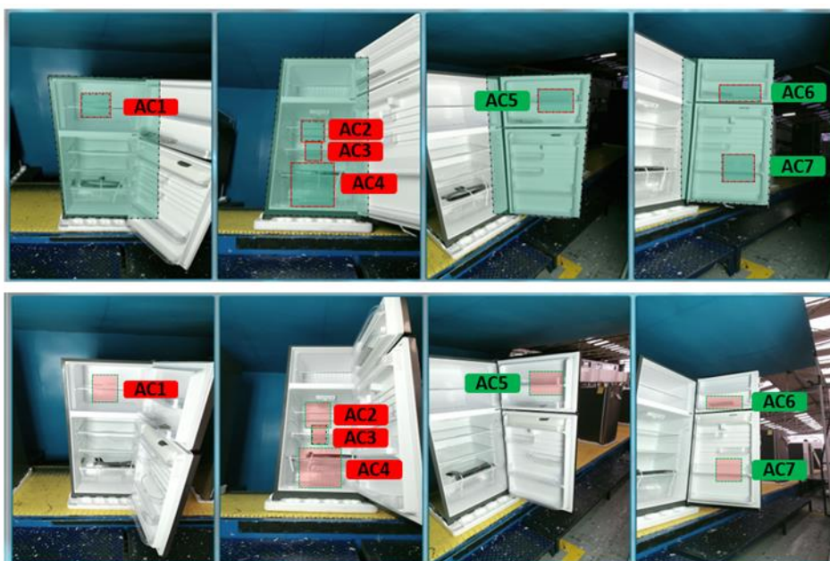
Fig. 13: Resultado de obtención de ROI's de accesorios en posición central de la imagen. Prueba realizada con una nevera perteneciente al modelo MCRMC390WACX. Imágenes del modelo de referencia en la parte superior y de la prueba en la parte inferior.
